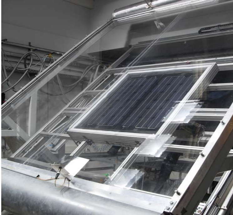
Messung am Indoor - Solarsimulator des Fraunhofer ISE
