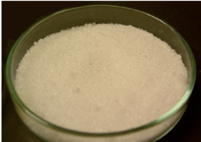
Abbildung 25: Probe Magnesiumsulfat-Pulver – eines der thermochemischen Materialien, die untersucht werden.
