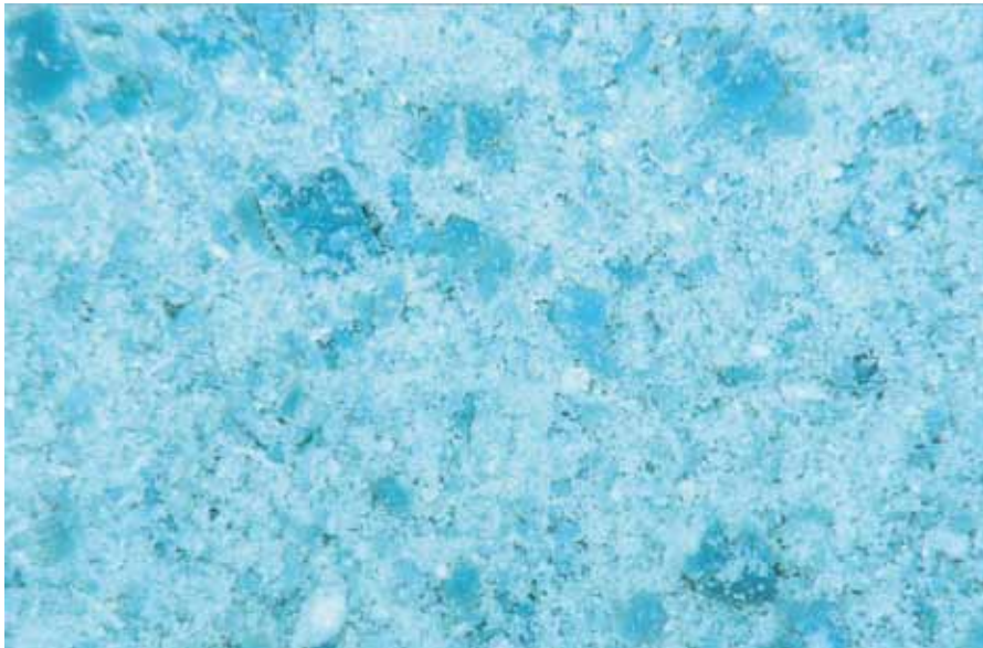
Mikroskopaufnahme Sorptionsmaterial (Metal organic framework, MOF) für erhöhte Speicherdichten
